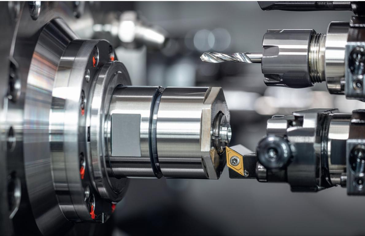
1 Quasi neu entwickelt: Mit der Traub TNL 12 bieten die Index-Werke die zweite Generation des erfolgreichen Drehautomaten an, der sich nunmehr flexibel und schnell zwischen Lang- und Kurzdrehern umrüsten lässt © Index-Werke
