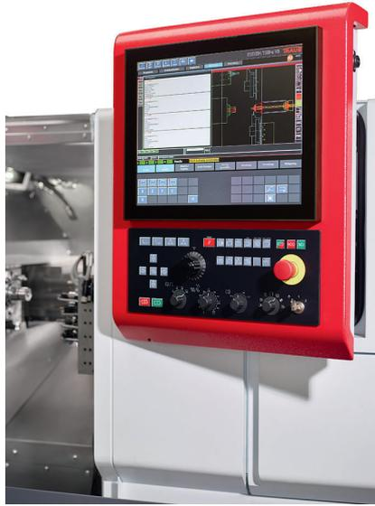
3 Alle relevanten Daten für die Fertigung direkt an der Maschine: Die Steuerung Traub TX8i-s, die in gewohnter Weise »abwärtskompatibel« ist und sämtliche Altprogramme 1:1 übernehmen kann © Index-Werke
